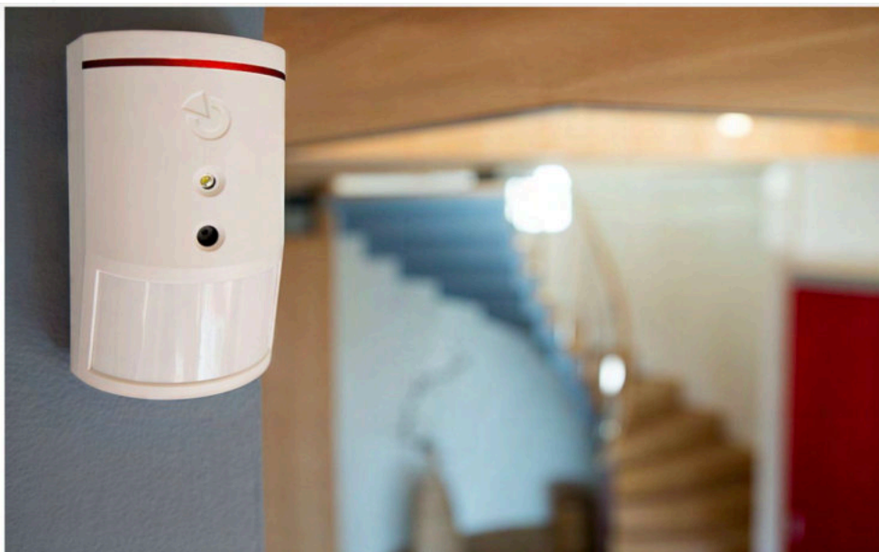
PIR detektor pohybu může být kombinovaný s kamerou. Při zaznamenání pohybu pořizuje kamera detektoru barevný snímek.
